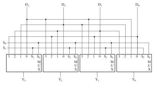
☐ **FIGURE 8-9**4-Bit Barrel Shifter
